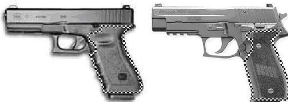
Il nastro antiscivolo può essere applicato unicamente sulle aree delimitate dalle linee tratteggiate, che includono la porzione anteriore e quella posteriore dell'impugnatura. In ogni caso, il nastro non può essere utilizzato per disattivare una sicura posta sull'impugnatura, né può essere applicato su alcuna parte del carrello, del grilletto, della guardia del grilletto, del caricatore o di alcuna leva o bottone.
